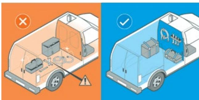
5. Separação total entre a cabine do condutor e o compartimento de carga (parede divisória do piso ao teto).
