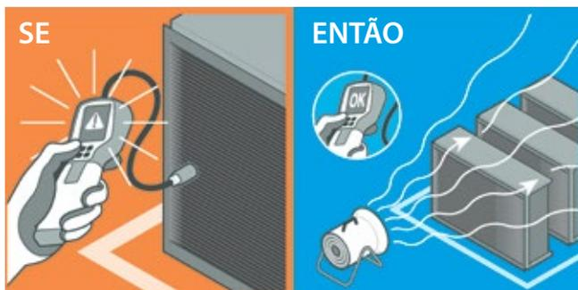
**11.** Em caso de fuga, utilizar um ventilador portátil (ATEX) para permitir a ventilação em torno da unidade.
