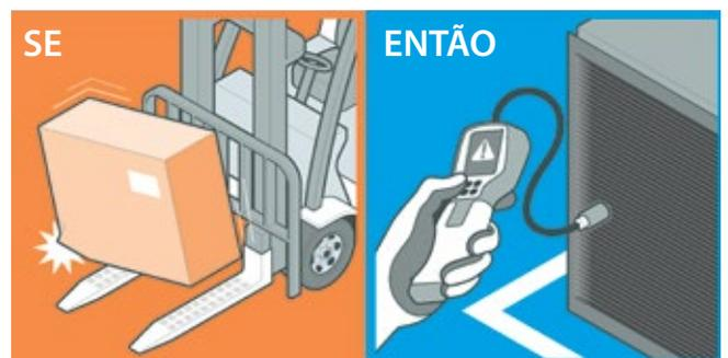
**8.** Verificar a existência de fugas, em caso de queda de uma unidade, durante o manuseamento.
